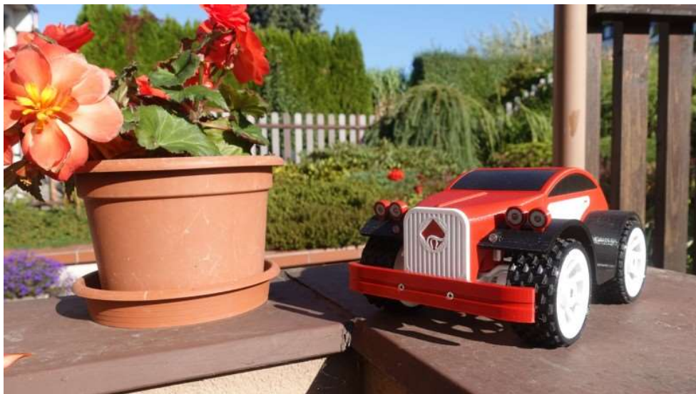
Finální provedení exteriéru prototypu modelu s funkčním osvětlením, blinkry a brzdovými světly
