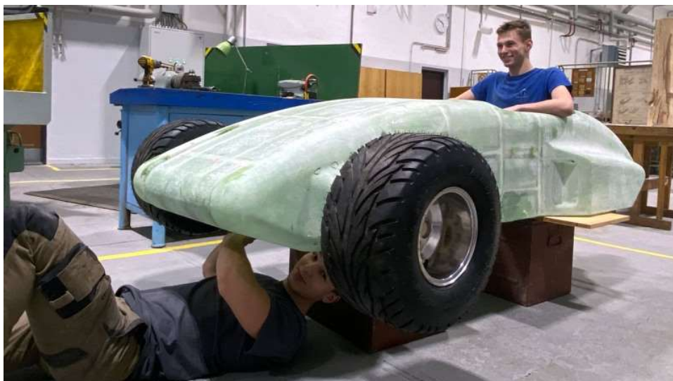
Montáž sestavy karoserie a podvozku ve školních dílnách na VOŠ a SPŠ ve Žďáru nad Sázavou
